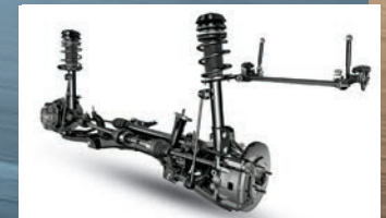
Suspensión delantera de tipo McPherson y suspensión trasera semi independiente.
